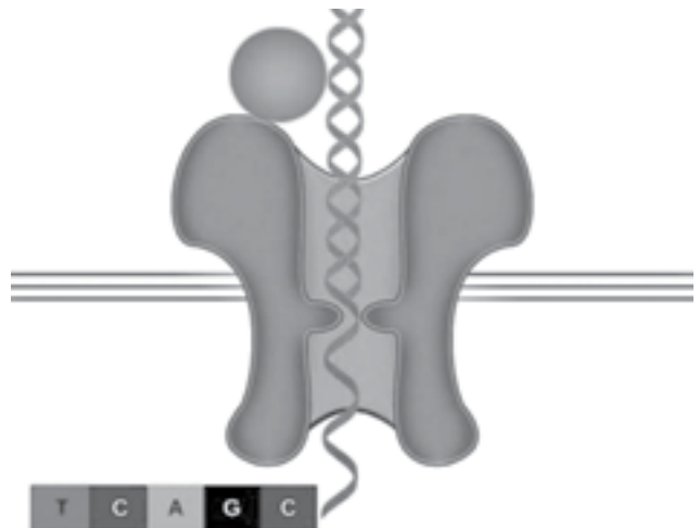
شکل ۲ - عبور مولکول DNA از میان یک پروتئین نانوحفره ای شکل [۳].
